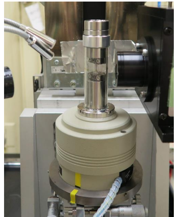
図 1 引張圧縮試験機 CT500
