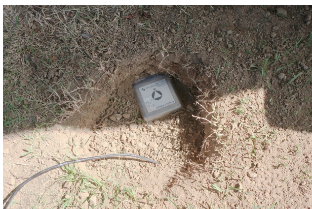
図2 地震計の埋設
