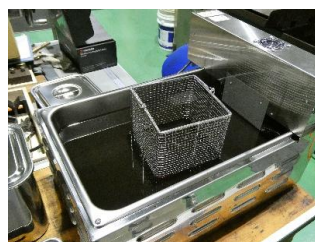
図4. 油槽での急冷作業
