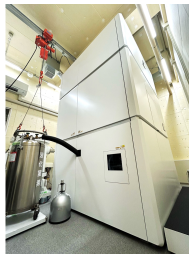
図 1 クライオ TEM 装置 (CRYO ARM 300 II, JEOL) 高さ約 4 m のエンクロージャー に TEM が収められている。
