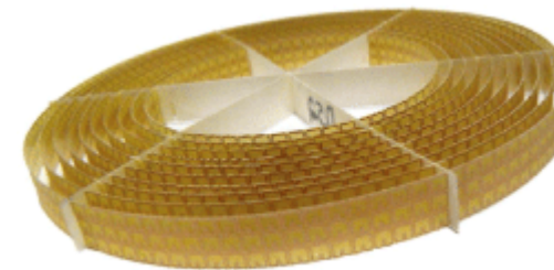
GHz帯でのcloaking用 メタ材料
