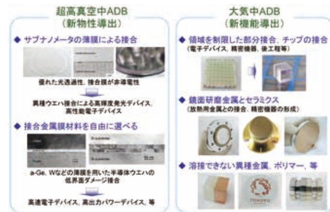
図 1 新しい室温接合技術 (原子拡散接合法、ADB)
