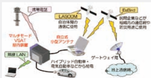
図1 今回開発したマルチモード VSAT を用いたシステムの概要
