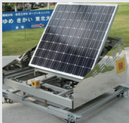
図1 太陽追尾型小型ソーラパネル
