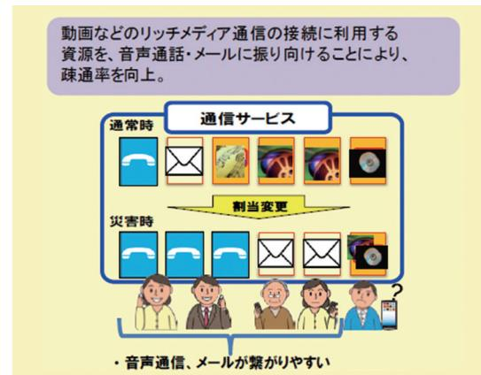
図1 通信処理リソースの動的制御技術
