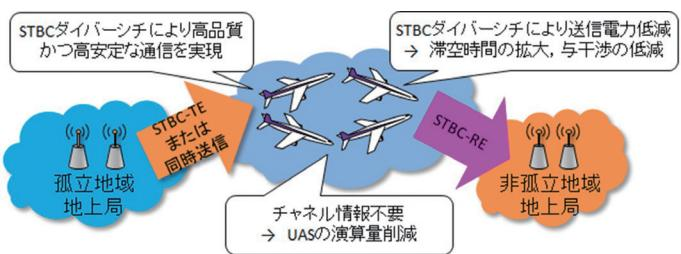
図2 地上・UAS連携マルチリンク MIMO協調中継技術
