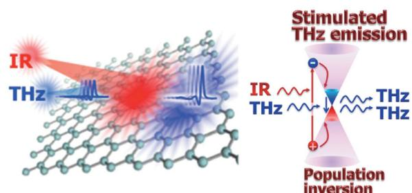
図1 光学(IR)励起グラフェンにおけるテラヘルツ(THz)帯利得作用とそれに付随する誘導放出現象
