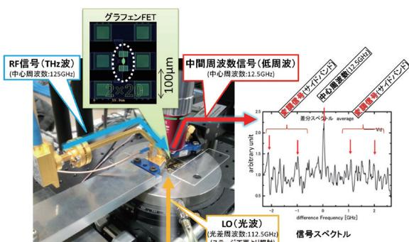
図2 グラフェンチャネルトランジスタによる光電子融合ダブルミキシングの実験
