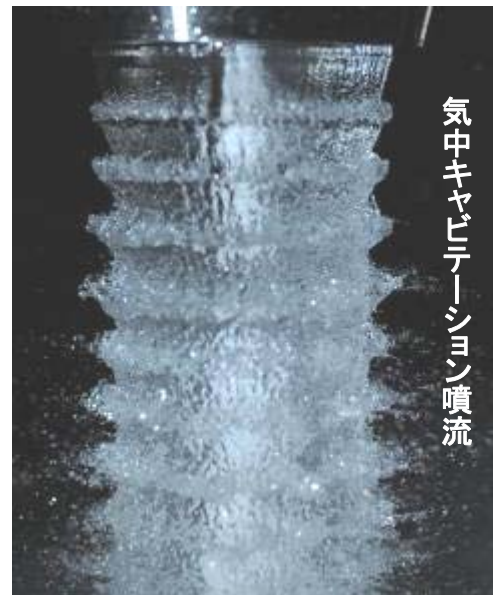
図13 キャビテーション噴流の概要ならびに様子
