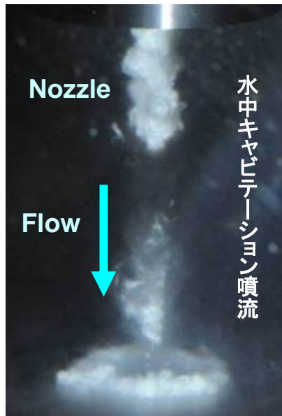
図13 キャビテーション噴流の概要ならびに様子
