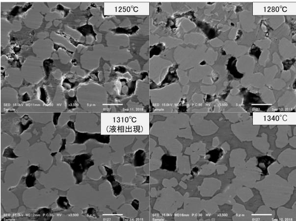
WC-Co合金の焼結過程(実験)。図中の温度は焼結温度。低温では、WC粒子間にCoがある。高温では、WC粒子同士が多く接触している。これらをMCシミュレーションと比較することにより、より詳細な材料設計ができる。
