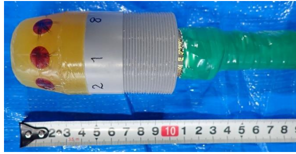
図5 円錐孔壁ひずみ法用の24素子ストレインセル
