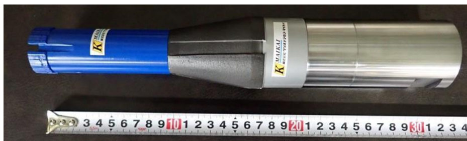
図4 円錐孔壁(仕上げ用をセット)とカッティングス孔を加工するビット(青色部)
