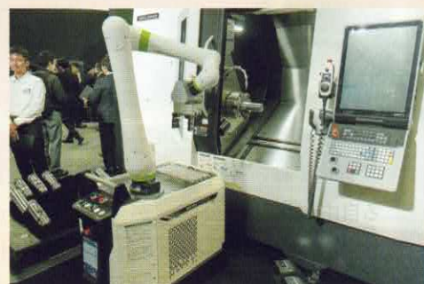
DMG MORI ブース。ロボットを使った加工機へのワーク脱着作業 『AI/Robot/IoT で変わる製造現場』より
