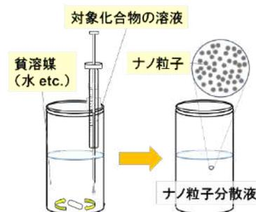
図2 再沈法の模式図
