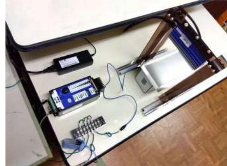
図3 作成した帯電量測定装置
