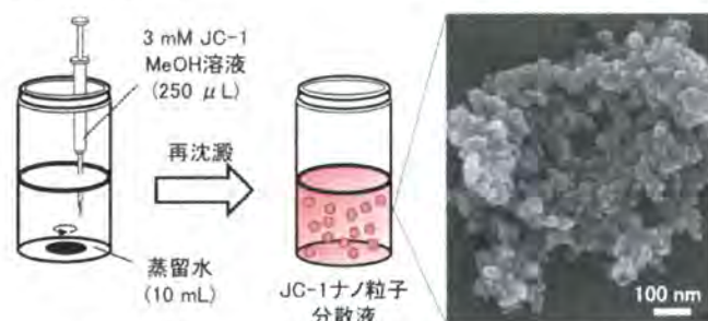
Fig.1 JC-1 ナノ粒子の作製と SEM 像
