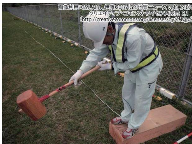
写真。極浅層反射法地震探査(S波)の様子。写真は、伊藤, 2016, GSJ地質ニュース, vol. 5, 240-243.より)。板を叩くことにより微小な波を発生させる。道路脇には地震計(写真背後の黄色)を設置し、地下の地層からの反射波を観測し、解析により地下構造をイメージングする。
