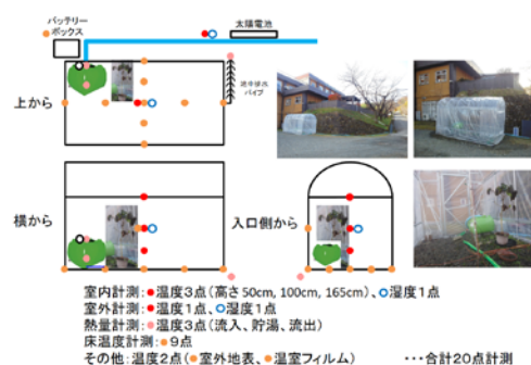
図 1. ハウスの設置位置の写真と温度/湿度センサーの設置場所の概略図
