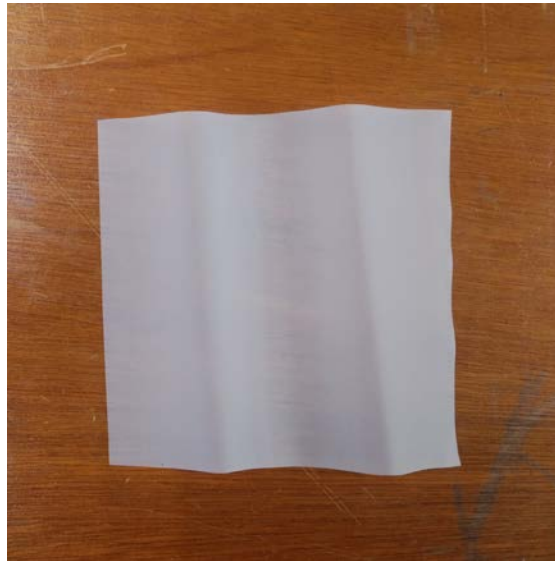
図1 試作した誘電エラストマアクチュエータ用のポリアミド
