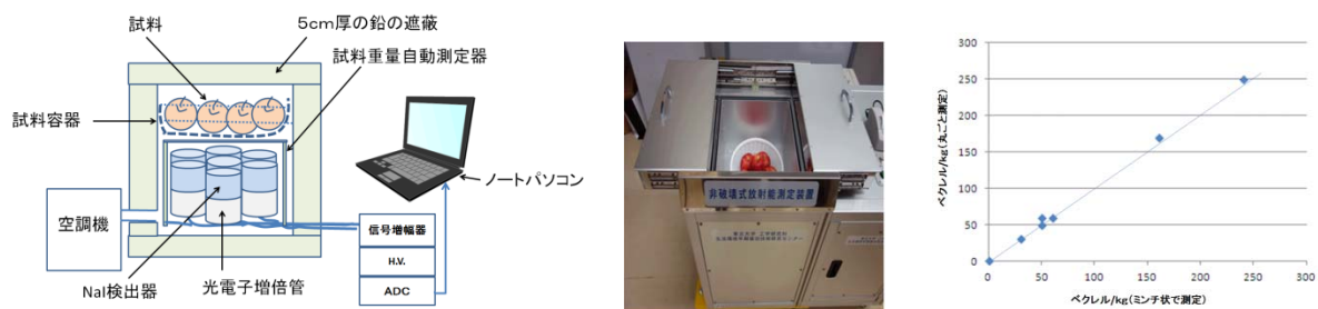
図1 マルゴト汚染検査器、マルゴトでもミンチ状と同じ結果を与える（右）。
