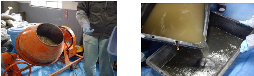
図1 ポットミキサーで汚染稲ワラを水洗浄（左）、その残留水（右）
