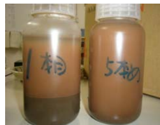
図2 除染の様子(左)とアスファルトを除染して吸引された汚染水
