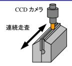
光学系に傾斜がつくことによる輝度変化の影響、 ワーク表面の反射率による輝度変化の影響を除去
