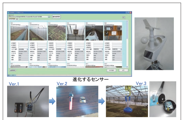
図 2 定点型センシングシステム（機能試作）事例
