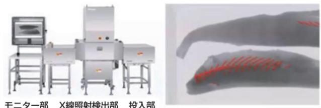
X線残骨検査装置 立体情報による小骨検出 (赤色が自動検出された箇所)
