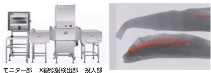
モニター部 X線照射検出部 投入部
