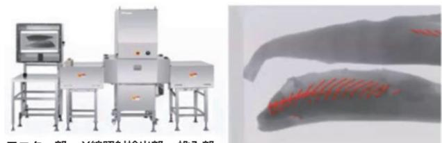
X線残骨検査装置 立体情報による小骨検出 (赤色が自動検出された箇所)
