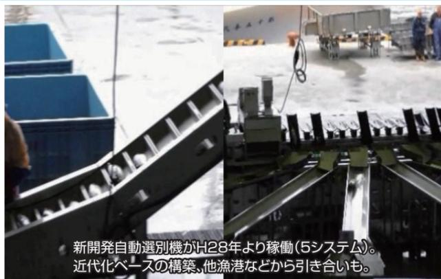
新開発自動選別機がH28年より稼働(5システム)。近代化ベースの構築、他漁港などから引き合いも。
