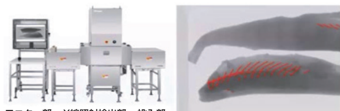
モニター部 X線照射検出部 投入部
