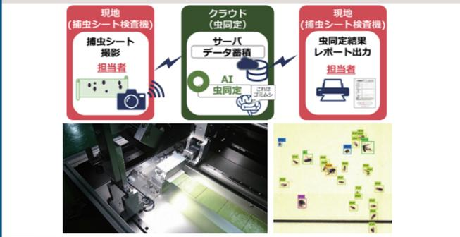
対象 ●目視による虫同定の自動化とIT技術を活用した評価・報告システムの迅速化。アタッシュケースサイズのコンパクト可搬型画像撮影・解析システムによる現場に於けるリアルタイム解析と評価報告書の作成。生産性と顧客満足度の向上を実現。
