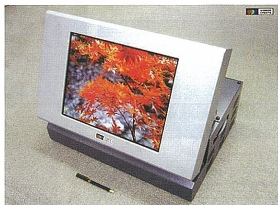
試作したFS型カラー液晶ディスプレイ(15型XGA)
