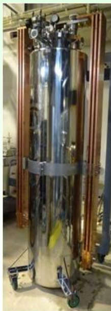
大型超伝導導体通電試験装置 (1万アンペア・液体ヘリウム冷却) 橋爪・遊佐・伊藤研
