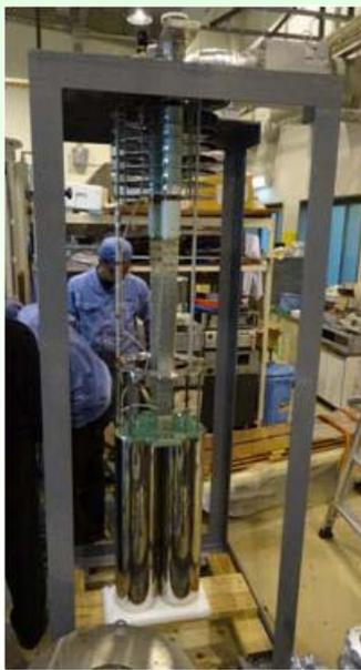
大型超伝導導体通電試験装置
