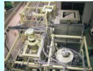
高温溶融塩循環ループ (溶融塩伝熱実験)
