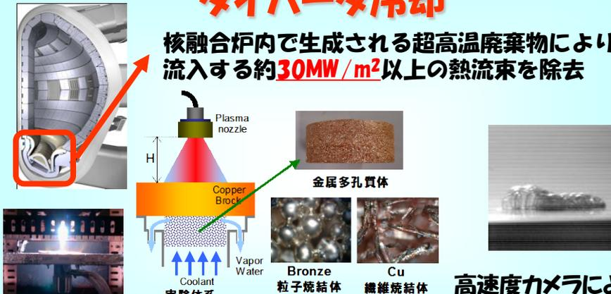
金属多孔質体を用いた超高温熱流束除去技術の開発
