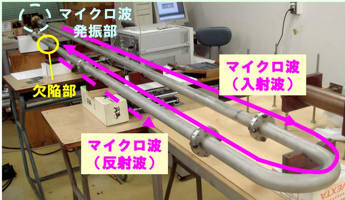
マイクロ波非破壊検査試験体系
