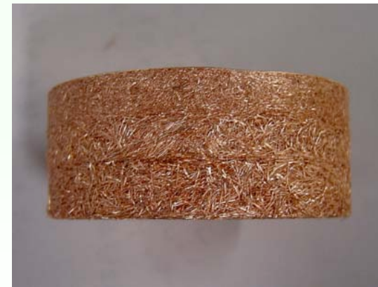
傾斜多孔質体 ( \epsilon=70\% , d=30/60/90\ \mu\text{m} )
