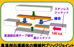
高温超伝導テープ線材の機械的ブリッジジョイント
