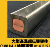
大型高温超伝導導体 (100 KA 1時間通電 at 4.2 K 実証)
