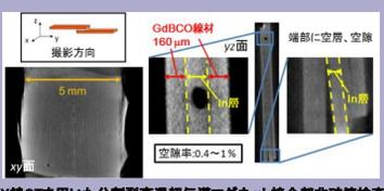
X線CTを用いた分割型高温超伝導マグネット接合部非破壊検査
