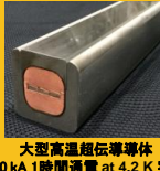
大型高温超伝導導体 (100 KA 1時間通電 at 4.2 K 実証)
